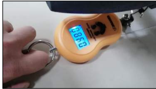
Şekil 43. Gt 2820/07 motor, 10x5.5 pervane örnek itki testi
