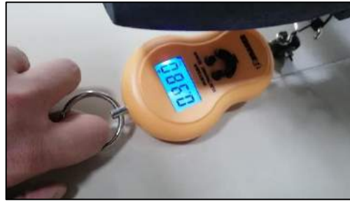
Şekil 43. Gt 2820/07 motor, 10x5.5 pervane örnek itke testi
