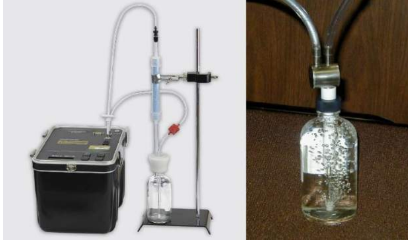
Şekil 5. RAD H 2 O aksesuarının RAD-7 dedektörüne bağlanması ve su numunelerinin köpürtülmesi.
