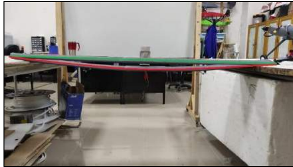
Şekil 46. Köpük kanadın yük altında eğrilme görüntüsü
