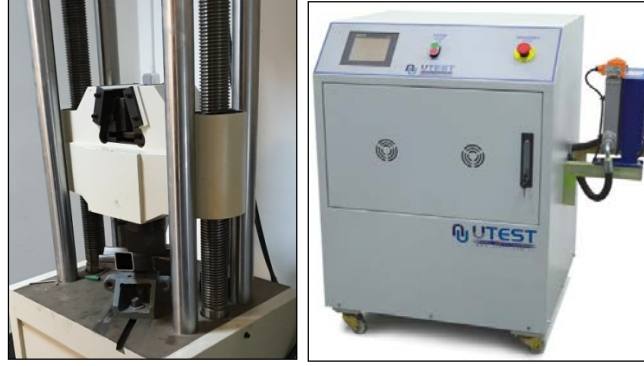
(a) (b) Şekil 2.3. Test cihazı (a) Çekme test cihazında yapılan eğilme test ortamı, (b) Servo kontrollü güç ve bilgisayar ünitesi [7]
