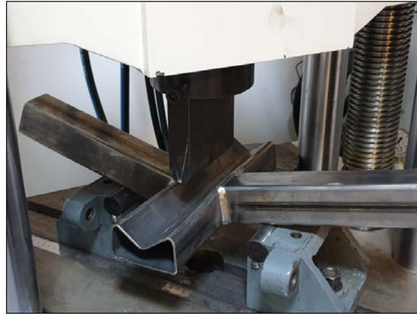
Şekil 2.6. Üç nokta eğilme testi sonucunda eğilmiş durumdaki çelik-profil numune
