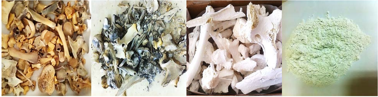
Şekil 1. a: Basınçlı tencerede 2 saat kaynatılmış ve % 5 NaOH ilave edilen çözeltilerde, 4 defa 30 dakika kaynatma işlemi yapılmış kemikler. b: 350 °C ‘de 2 saat ön kalsine işlemi uygulanmış kemikler. c: 700 °C ‘de 4 saat sinterlenen kemikler. d: Zirkonya bilyeler ile 24 saat boyunca değirmende öğütülen kemikler.
