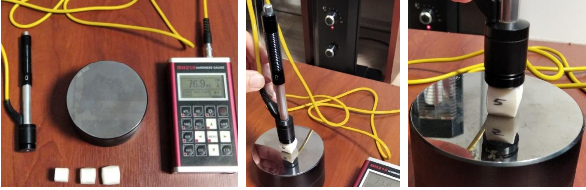
Şekil 7. MH210 yüzey sertlik cihazı ile numunelerin yüzey sertlik ölçümlerinin görüntüleri
