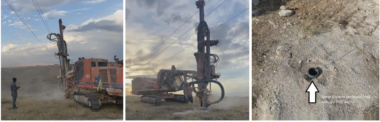
Şekil 7. Burgu Makinesi Tamrock Ranger 780 ile deney sahasında yapılan delme işlemi ve ivme ölçer yerleştirilmesi
