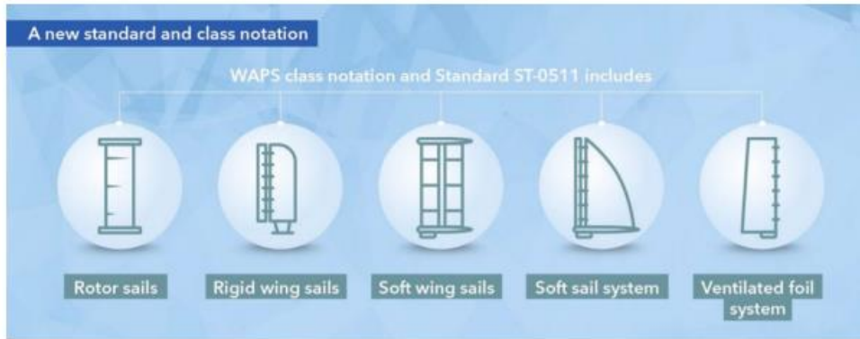
Resim-4: Emisyon Azaltmak Amacıyla Geliştirilen Yelken Türleri (Tay vd., 2023).
